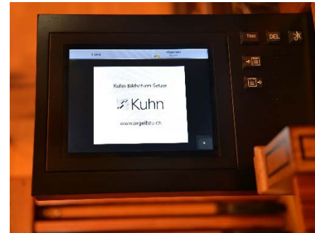
Touchscreen der Setzeranlage
