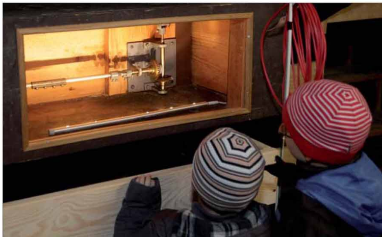
Faszinierende Mechanik sichtbar gemacht. Eine der Stationen der neuen Führung «Erlebnis Hofkirche» zeigt, wie über Stangen und Zahnräder die Bewegung vom Uhrwerk auf die Zeiger der grossen Uhr an der Hofkirche übertragen wird. Foto: Th. Lang
